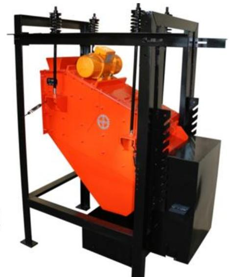
**Tamizador:** Fabricado en plancha de acero A36, con caja y sistema de porta bandejas, que incluye 6 bandejas de selección con mallas en tamaño a elección del cliente. Incorpora sistema de fijación Hidráulico.
